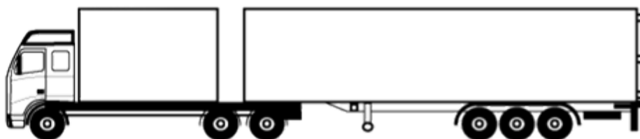
Camion + plateau d'accouplement + semi-remorque
